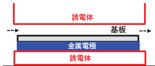
(b)片側金属電極構造(誘電体－金属電極)
