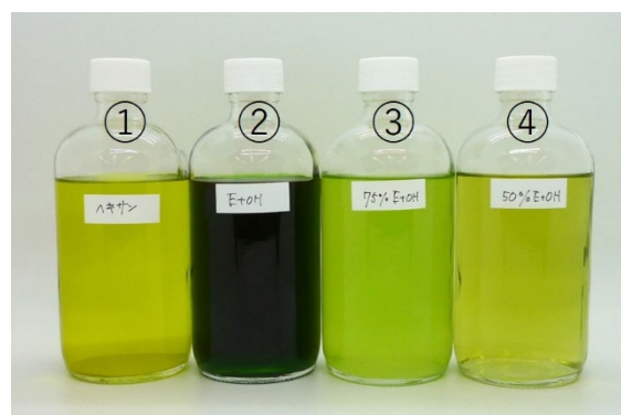
図 3 高速溶媒抽出法によるコゴミの抽出液 ①ヘキサン, ②エタノール, ③75%エタノール, ④50%エタノール
