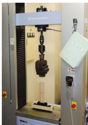
図 7 材料試験機による引張試験の様子
