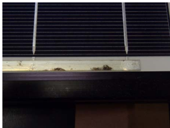
図 7 DH1000 時間試験後にモジュール A-1 で発生したセル間配線部の黒色部
