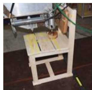
図5 JIS規格に定められた強度試験風景
