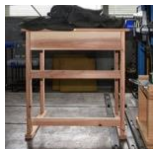
図5 JIS規格に定められた強度試験風景
