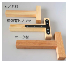
荷重試験による補強効果の検証
